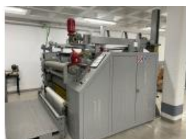
Referencia: M-1679 CALANDRA PARA LAMINACION Año: 2002 Marca: BERGI Ancho mesa: 1900
