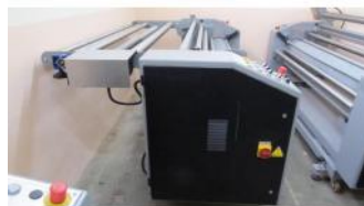
Referencia: QTX-010 DESENROLLADOR DE TEJIDOS Año: 2005 Marca: STI SERVIZI TECNICI INTEGRATI Ancho mesa: 1940
